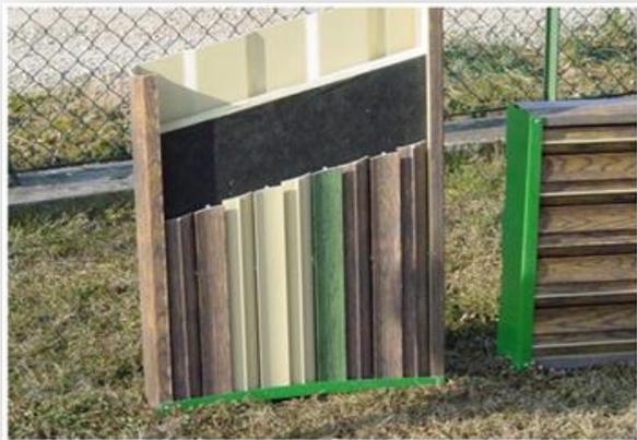
Устройство звукопоглощающей панели в разрезе
